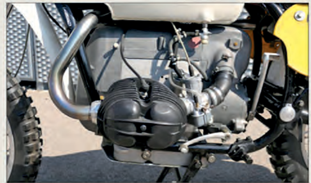
Die unteren Kälblippen und die Ölschnecke auf der Unterseite des Motors wurden zu Gunsten der Gewichtserparnisung und der Bodentriebel entfällt.
