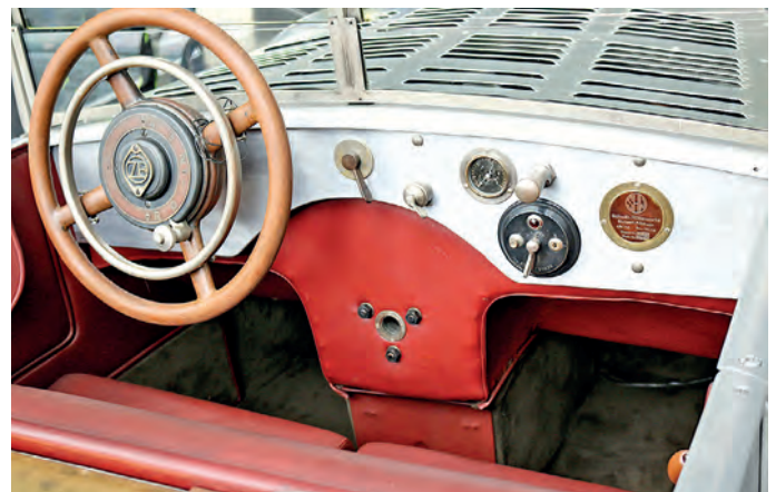
Das sehr spartanische Armaturenbrett mit dem Schalthebel für das Soden-Vier-Gang-Getriebe der ZF (Leihgabe Deutsches Museum München).
